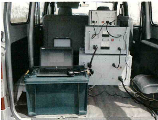
写真 1 送信機機材 一式(左: 送信機材、右: 送信アンテナと電極)
