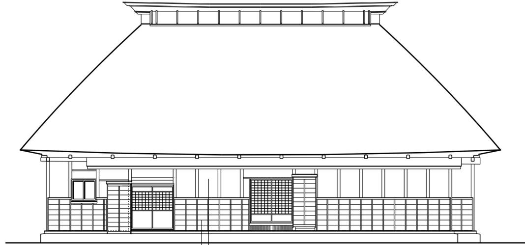
外壁—木舞下地真壁土塗り中塗り仕上げ
