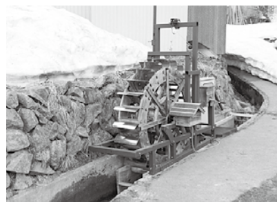
馬曲地区内に設置されたマイクロ水力発電機
